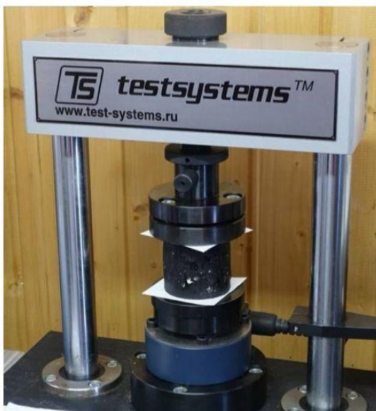
6 - сурет – Суға төзімділікті анықтауға арналған механикалық құрал
