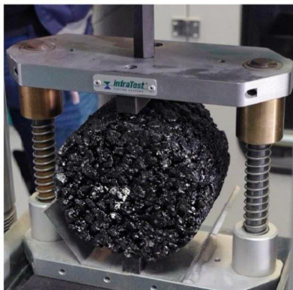
6 - сурет – Суға төзімділікті анықтауға арналған механикалық құрал
