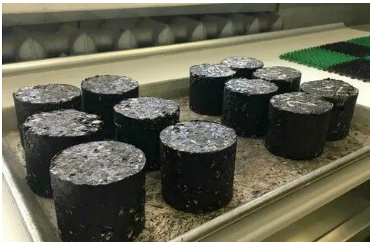
3 - сурет – Асфальт қоспасынан алынған сынақ үлгілері
